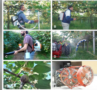
Fig. 6 Macchine usate nelle prove comparative. A. distributore a secco polline-licopodium 12V "Speedy" (Dell'Agata, Forlì) (operatività 5-7 h/ha); B. distributore a liquido modello Hozelok con pompa a diaframma 12V (4h/ha); C. distributore a secco di puro polline "SoffiaPolline" (Biotac, Verona) (1 h / ha); D. macchina trattore per distribuzione a liquido (Gerbaudo, Cuneo) (2 h / ha); E. impollinazione manuale "pon-pon" (25 h / ha); F. "Ventole" (Romani, Verona) (0,5 h / ha).
